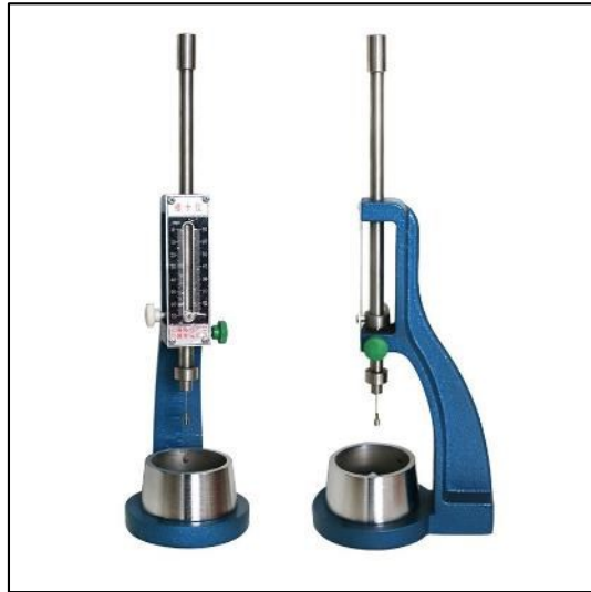
Gambar 15. Alat vicat sesuai standar ASTM C-91-82
