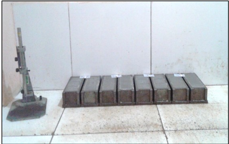
Gambar 10. Benda uji bentuk kubus ukuran 5x5x5 cm
