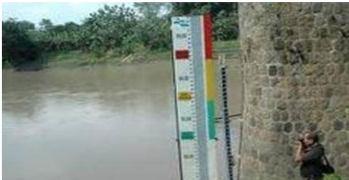
Gambar 2.10 alat ukur bendung yang difungsikan sebagai pengukur aliran sungai
